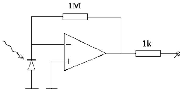
Преимущества схемы — высокая линейность, малые шумы, высокий коэффициент передачи. При указанной полярности включения фотодиода под действием света на выходе операционного усилителя образуется положительное напряжение  $U_{вых} > 0$ .
