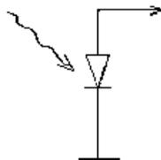
При указанной полярности включения фотодиода под действием света на выходе образуется положительное напряжение  $U_{вых} > 0$ .
